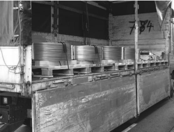
Abb. 5.4.5-4: *Praktisches Beispiel einer formschlüssig verstaute Ladung.*
