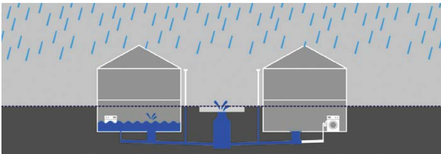
(4) Rückstausicherungen verhindern, dass ein hoher Wasserspiegel aus der Kanalisation am und im Gebäude austritt.
