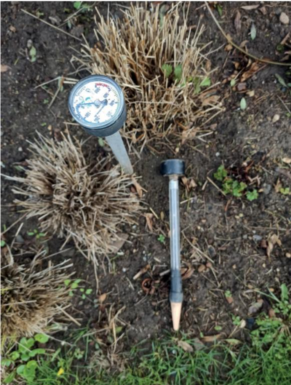
**Bild 1:** Tensiometer (Quelle: Thon)
