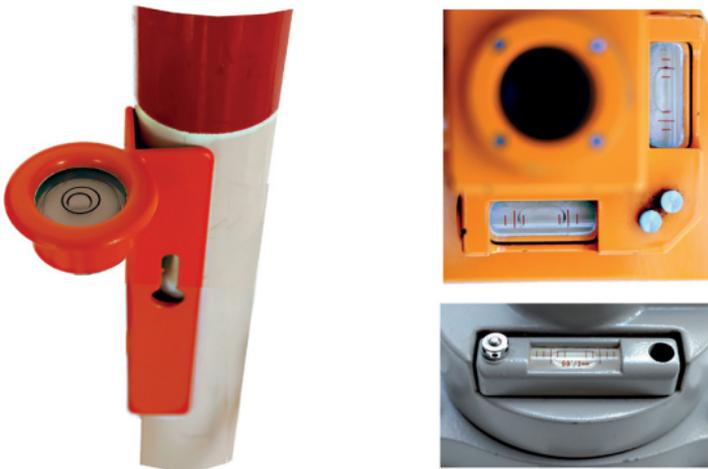
**Bild 3:** Links: Lattenrichter mit Dosenlibelle, (Hilfsinstrument zum Senkrechtstellen von Fluchtstab und Nivellierlatte) - Rechts oben: Röhrenlibellen-Kreuzlibellen - Unten rechts: Röhrenlibelle (vgl. Abschnitt Stativ und Libelle) (Quelle: Diebel)
