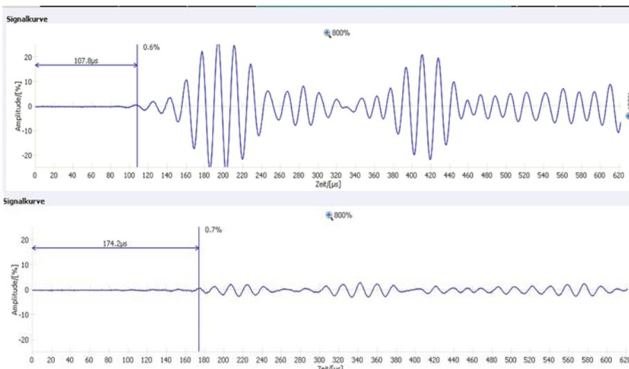
(5) Exemplarische Messsignale einer Ultraschallmessung im ungestörten Bereich (oben) und gestörten Betongefüge (unten)
