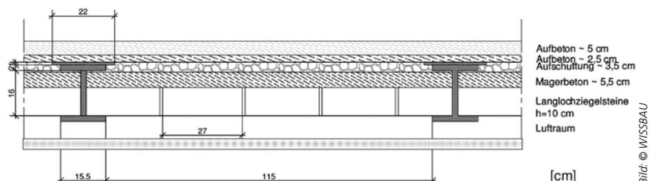
(1) Nachzuweisende Deckenkonstruktion; Annahme aus Bestandsstatik
