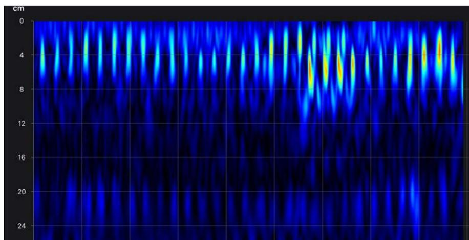
(3) Linienmessung Georadar einer Stahlbetondecke mit zweilagiger Bewehrung
