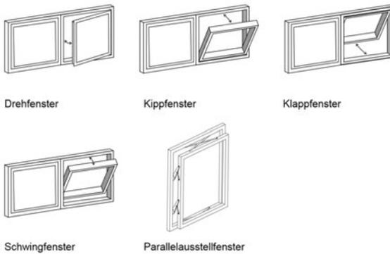
Abb. 4.6.1-1: Bauarten von Fenstern, (Quelle: ASR A1.6)
