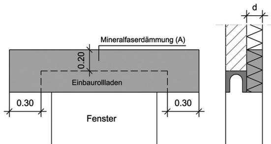
Abb. 5.7.4-4: Einbaurollladen – im Neubau eingebaut (Quelle: C. Uske)
