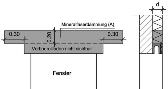
Abb. 5.7.4-7: Vorbaurollladen – auf die Wand montiert und überdämmt (Quelle: C. Uske)
