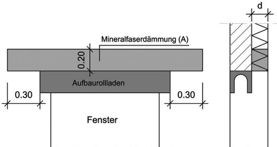
Abb. 5.7.4-5: Aufbaurollladen – meist sichtbar auf das Bestandsfenster aufgesetzt (Quelle: C. Uske)
