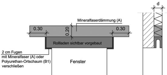
Abb. 5.7.4-6: Vorsatzrollladen – sichtbar auf die Wand montiert (Quelle: C. Uske)
