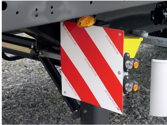
Abb. 5.4.6-11: Seitlich ausziehbare Warntafel mit Beleuchtung bei Überbreite
