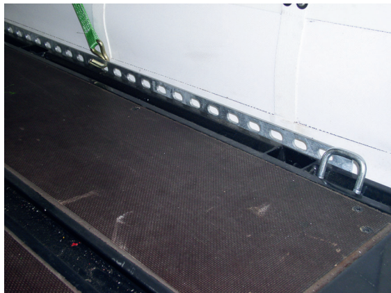
Abb. 5.4.6-9: Aufbauboden mit C-Schiene im Vordergrund
