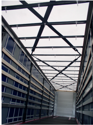
Abb. 5.4.6-5: Spezieller Fahrzeugaufbau für die Reifenindustrie mit zusätzlichen Rungen + Einstecklatten (Curtainsider mit verstärktem Fahrzeugaufbau Code XL) (Innenansicht)
