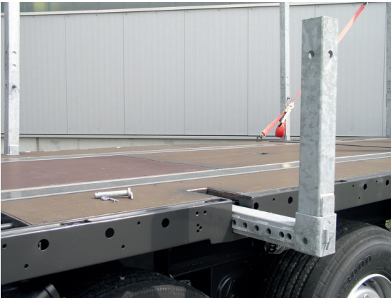
Abb. 5.4.6-10: Seitlich ausziehbare Rungen für Transporte mit Überbreite ermöglichen bei formschlüssiger Beladung im Bedarfsfall eine seitliche Abstützung des Transportgutes
