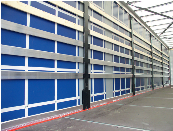
Abb. 5.4.6-3: Lkw mit Curtainsider mit verstärktem Fahrzeugaufbau Code XL und eingenähten textilen Gurten im Dachbereich (mit einem 3-fach Diagonalgurtkreuz im Dachbereich) (Innenansicht)
