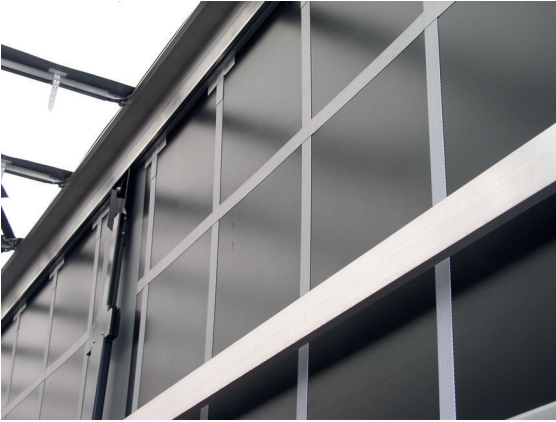
Abb. 5.4.6-4: Speziell für die seitliche Belastung ausgelegte Dachholmausführung (Slimliner Large (bei Mega-Trailern)), die bei Bedarf ein seitliches Abstützen der Ladungsträger ermöglicht
