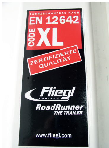
Abb. 5.4.6-6: Kennzeichnungsaufkleber für den verstärkten Fahrzeugaufbau Code XL
