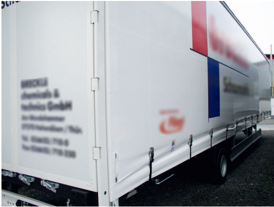
Abb. 5.4.6-1: Standard-Fahrzeugaufbau Code L, zusätzlich erfüllten Stirn- und Rückwand die Anforderungen des Codes XL, jedoch die Seitenwände nicht (Außenansicht)
