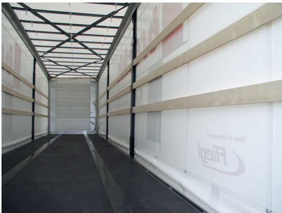
Abb. 5.4.6-2: Standard-Fahrzeugaufbau Code L, zusätzlich erfüllten Stirn- und Rückwand die Anforderungen des Codes XL, jedoch die Seitenwände, z. B. Mittelrungen und Planenspanner, nicht (Innenansicht)
