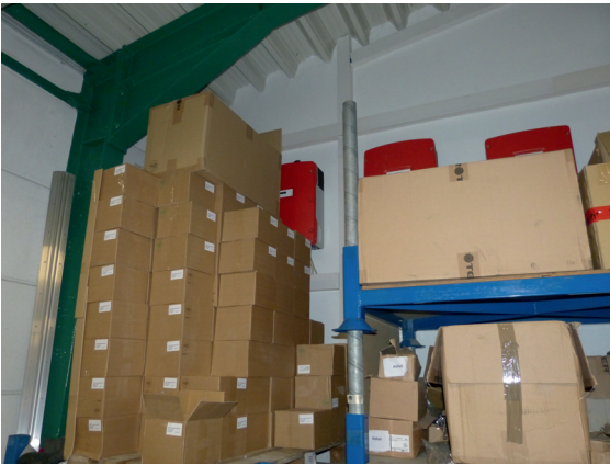
Abb. 3.7-7: Lagerraum (=feuergefährdete Betriebsstätte) mit brennbaren Materialien, Quelle: SV Schröder
