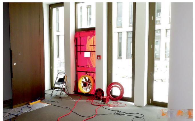
(1) Typischer Einbau eines Blower-Door-Messsystems zur Bestimmung des notwendigen Volumenstroms in  $m^3/h$  (Bild: © Uwe Münzenberg)
