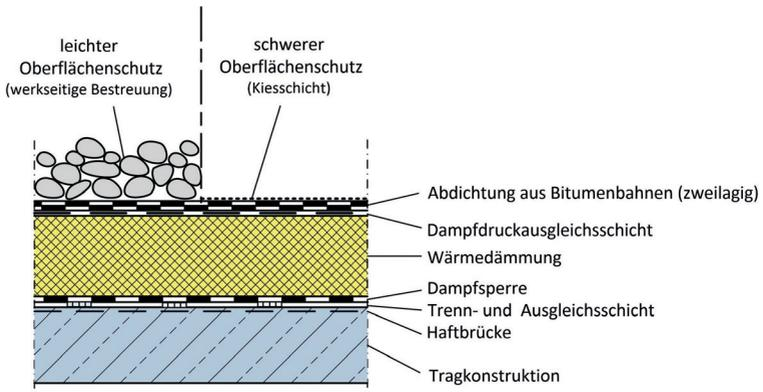
Bild 25: Nicht belüftetes Dach (Quelle: Schmidt)
