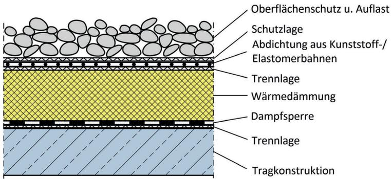
Bild 26: Nicht belüftetes Dach (Quelle: Schmidt)
