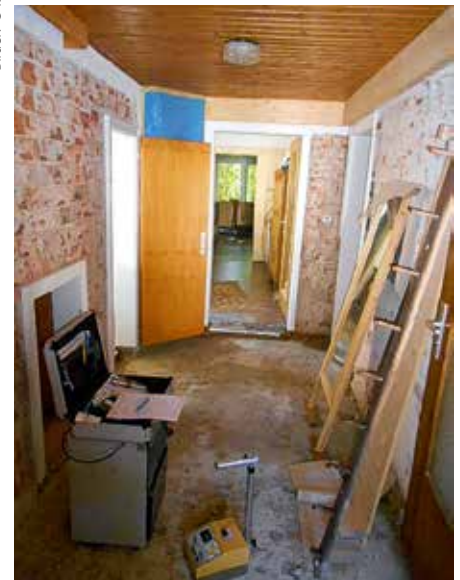
(5) Feuchtemessungen mittels Neutronen-sonde
