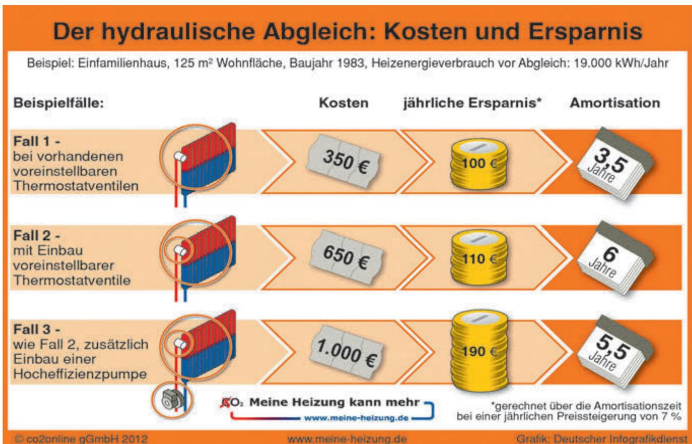
Beispielrechnung Hydraulischer Abgleich - Einfamilienhaus, 125 m<sup>2</sup>, freistehend, Jahresheizenergiebedarf 150 kWh/m<sup>2</sup>.
