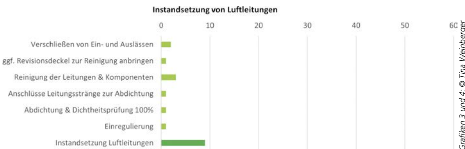
(4) Dauer in Tagen für die Instandsetzung von rund 1.000 m 2 Luftleitungssystem
