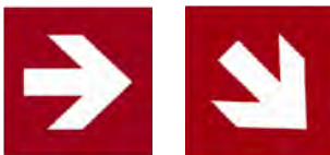
Abb. 1: Richtungspfeile für Brandschutzzeichen
