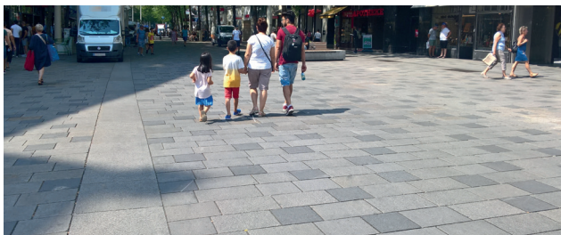
(14) Platten im Reihenverband, enge ungebundene Fuge und ebene sandgestrahlte Oberflächen eines geschnitten Granitmaterials ermöglichen einen lärmarmen Pflasterbelag (Wien). (Bild: © Walter Zimmerer)
