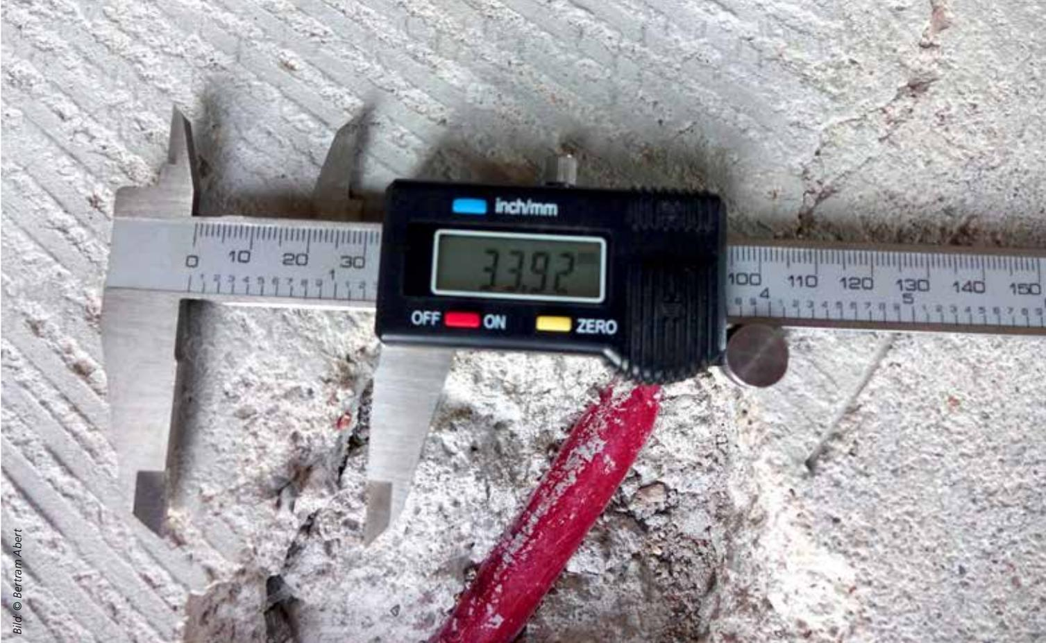
(1) Eine zu geringe Estrichdicke von 33 mm bei einem Standardestrich CT-F4 mit einer Fußbodenheizung der Bauart A: Bei solchen Mängeln ist meist ein Rückbau erforderlich.
