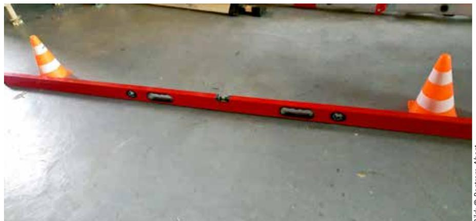
(4) Prüfung der Ebenheit mittels Messlatte und Messkeil
