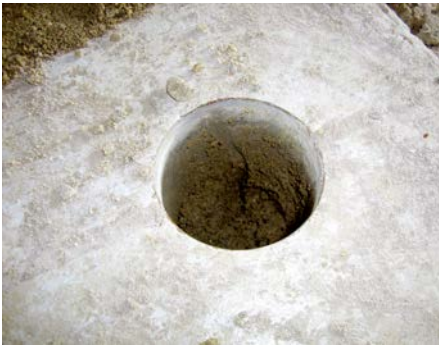
(4) Kernbohrungen zur Probeentnahme
